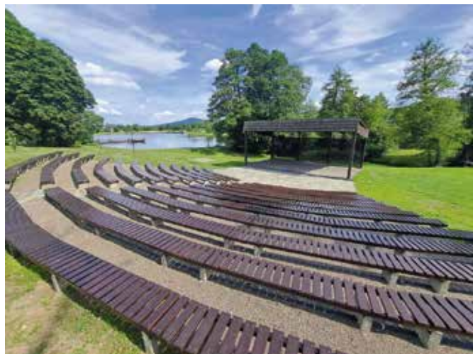
Powstały nowe ławki, a teren pod nimi oraz przejścia między siedziskami zostały utwardzone i ze względu na spadkowy charakter terenu zabezpieczono je krawężnikami.
